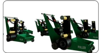
VERLEGEMASCHINE FÜR TEMPORÄRE MARKIERUNGSFOLIE
